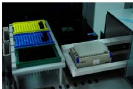
支持多种冻存管, 包括常规冻存管 (上左图) 和底部 2D 条码 (96 格管架式, 上右图)
